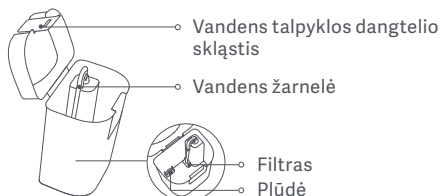
Švaraus vandens talpykla
